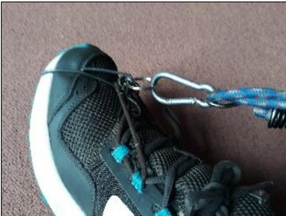
Photo 3 : Détails de l'arrimage à la pointe de la chaussure droite.
